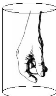
После приготовления смеси AL PR залейте ее в специально подготовленную емкость, предварительно опустив туда моделируемую часть тела (кисть руки, ступню, палец и т.д.). Держите ее в неподвижном положении, не касаясь дна и стенок контейнера (оставьте пространство по крайней мере в 1.27 см). Следует начинать лить материал в самую нижнюю точку контейнера и дать ему постепенно подняться до краев, окружая моделируемый объект.
